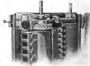
Fig. 26. Einbau des A. in den Fahrschalter.
